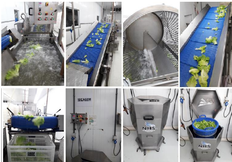
Figura 3. Terceira e quarta etapas: segunda correnteza para higienização, túnel, esteira transportadora das folhas e processo de secagem. Fonte: os autores.
